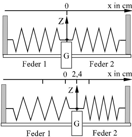
Die beiden Federn werden gedehnt und ihre freien Enden am Zeiger befestigt. Die am Gleiter angreifenden Kräfte halten sich das Gleichgewicht. In dieser Gleichgewichtslage ist der Zeiger Z zum Nullpunkt O der x-Achse gerichtet.
