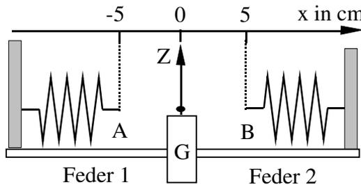
Die nebenstehende Skizze zeigt einen Gleiter G der Masse  $m = 180 \text{ g}$  auf einer Luftkissenfahrbahn. Am Gleiter ist ein Zeiger Z angebracht. Zur Versuchsanordnung gehören außerdem zwei gleiche, vorerst noch entspannte Federn, die jeweils die Federkonstante  $D_F$  besitzen.
